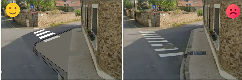
Exemple Rle St-Martin : Traversée piétonne sans abaissé de trottoir et ne respectant pas les principes généraux d'aménagement des passages piétons (orthogonalisation, distance à traverser, ...)
